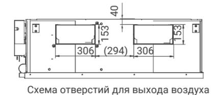
Схема отверстий для выхода воздуха
